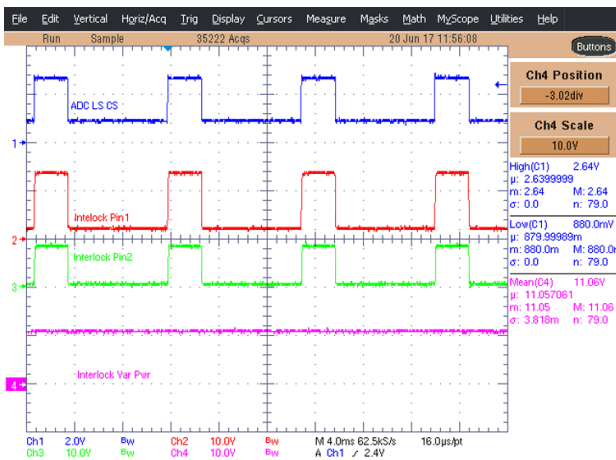
图 25. Interlock VCC at 11 V
