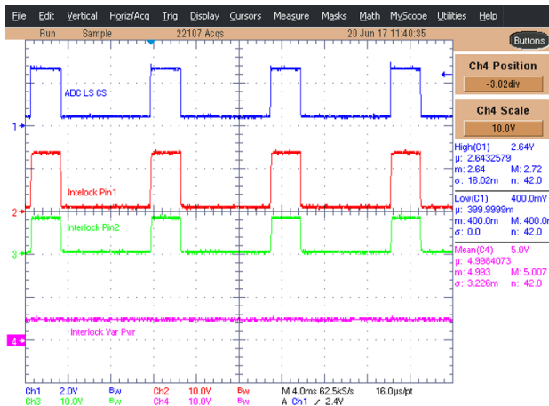
图 19. Interlock VCC at 5 V
