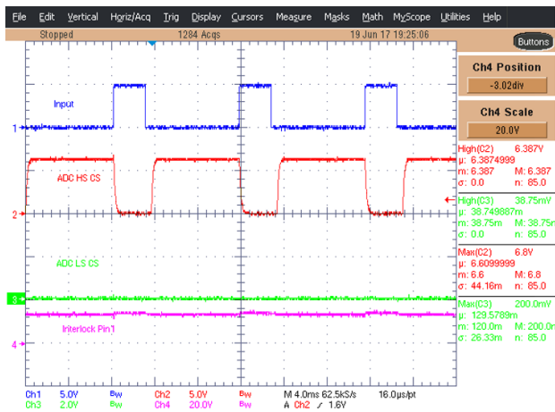
图 48. TIDA-01445 Open Load Condition
