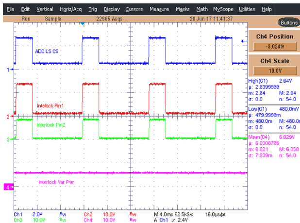
图 20. Interlock VCC at 6 V
