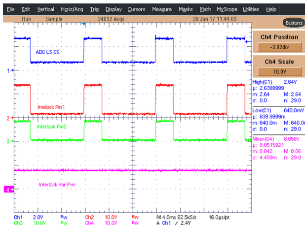
图 22. Interlock VCC at 8 V
