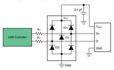
图 4. TPD2E001 Typical USB Application Diagram
