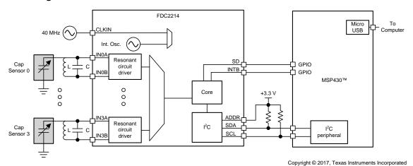
图 1. TIDA-01465 System Block Diagram
