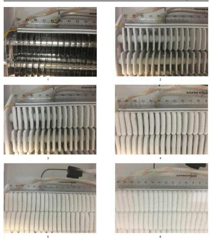
图 29. Frost Forming Process
