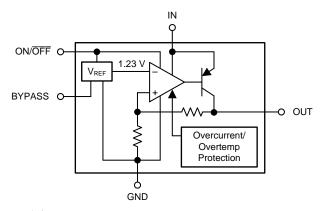
图 3. LP2985-N Functional Block Diagram
