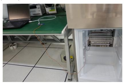
图 35. Long Cable Test Setup
