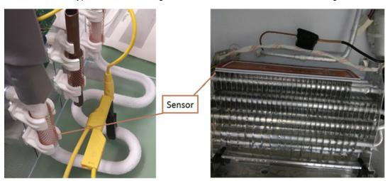
图 16. Capacitive Sensor
