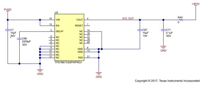
图 8. TPS7B6733-Q1 Linear Regulator Circuit
