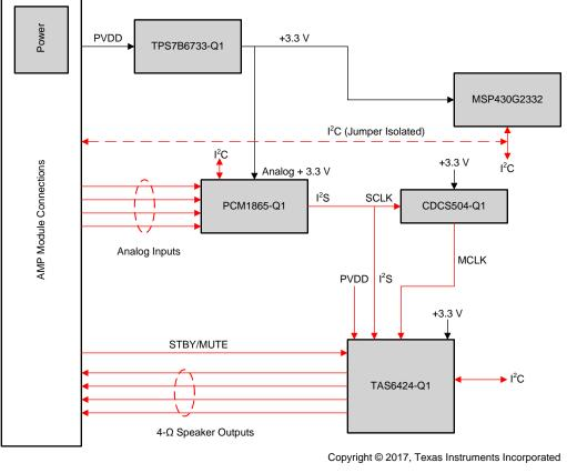
图 1. TIDA-00743 Block Diagram
