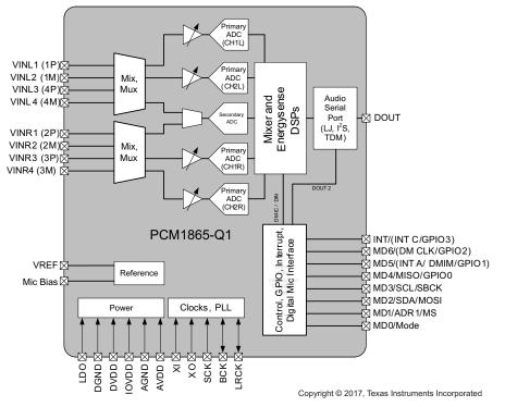
图 4. PCM1865-Q1 Simplified Block Diagram
