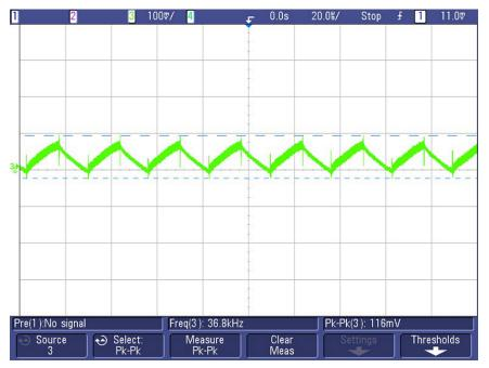
图 11. ISOW7841 DC Output Ripple
