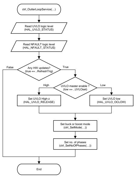
图 37. Flow Chart – Semi-Synchronous Control Loop Service
