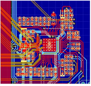
图 23. LM5170-Q1 Subsystem PCB Layout
