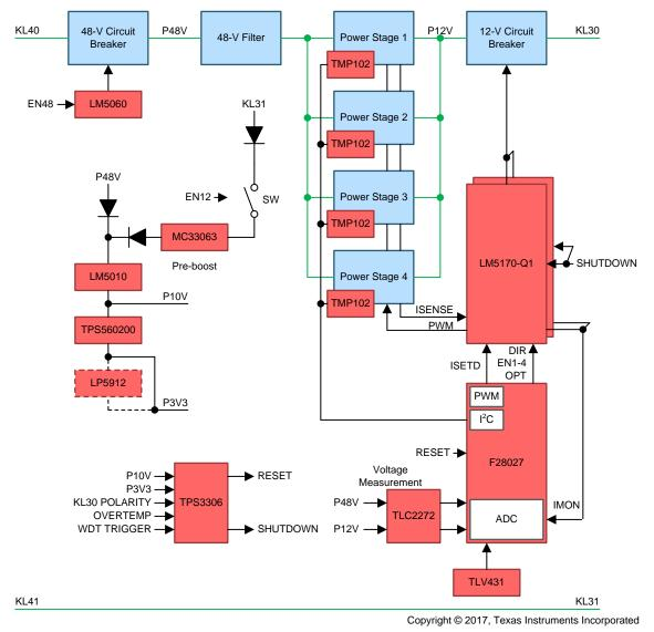
图 3. TIDA-01168 Block Diagram
