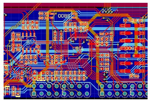
图 25. C2000<sup>™</sup> Control MCU PCB Layout
