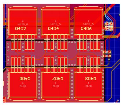
图 21. 12-V Circuit Breaker PCB Layout
