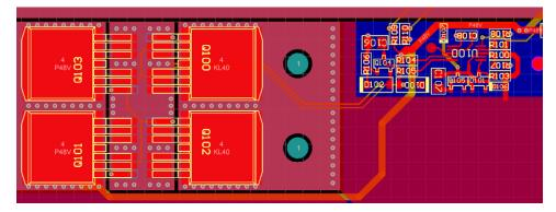
图 15. 48-V Circuit Breaker PCB Layout
