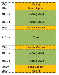
图 11. PCB Layer Stack for TIDA-01168
