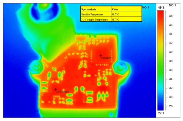
图 20. Thermal Measurement
