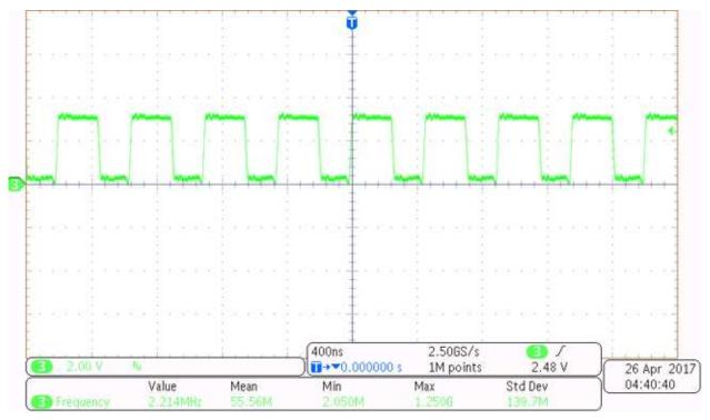
图 17. 1.8-V Switching Waveform
