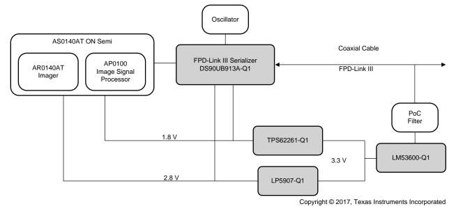
图 1. TIDA-01003 Block Diagram
