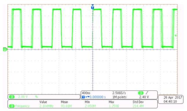
图 18. 3.3-V Switching Waveform
