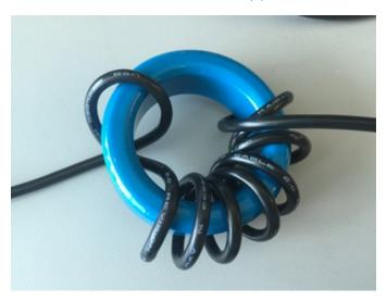
图 17. USB Cable Around Ferrite Bead
