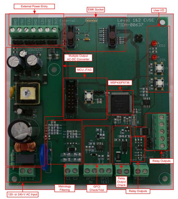
图 12. Top View of EVSE PCB
