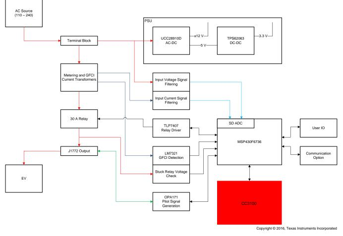
图 2. TIDC-EVSE-WiFi<sup>®</sup> Block Diagram
