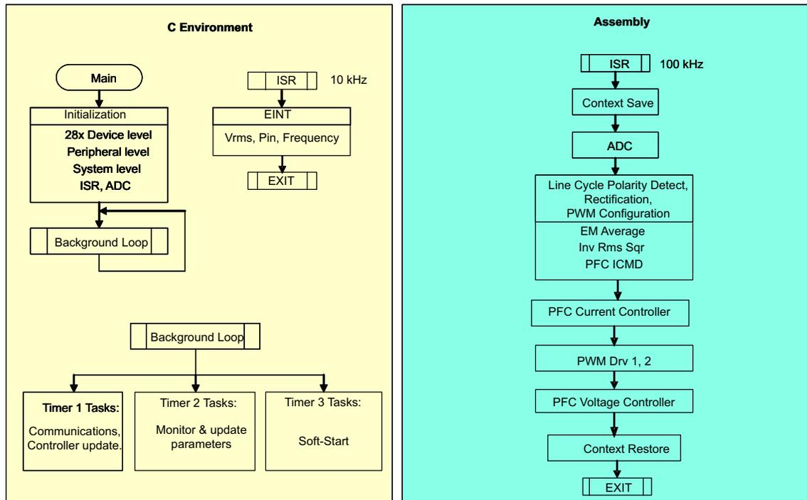
图 4. IL PFC Software Flow Diagram
