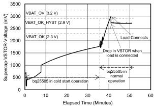
图 22. Supercap Charging Under 250 LUX
