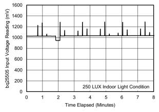
图 20. Input Voltage (250) LUX After Schottky Diode
