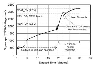
图 21. Supercap Charging Under 450 LUX
