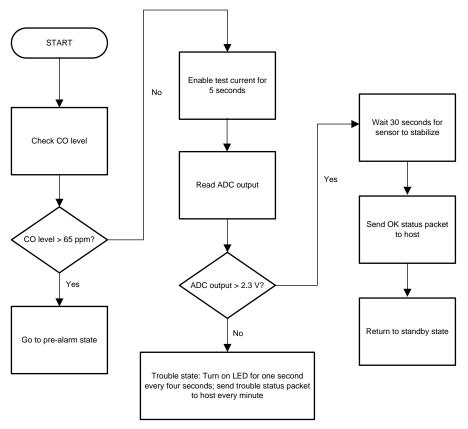
图 14. Sensor Test Procedure
