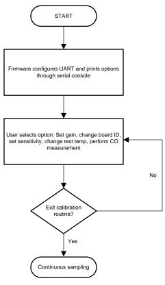
图 15. Calibration Procedure
