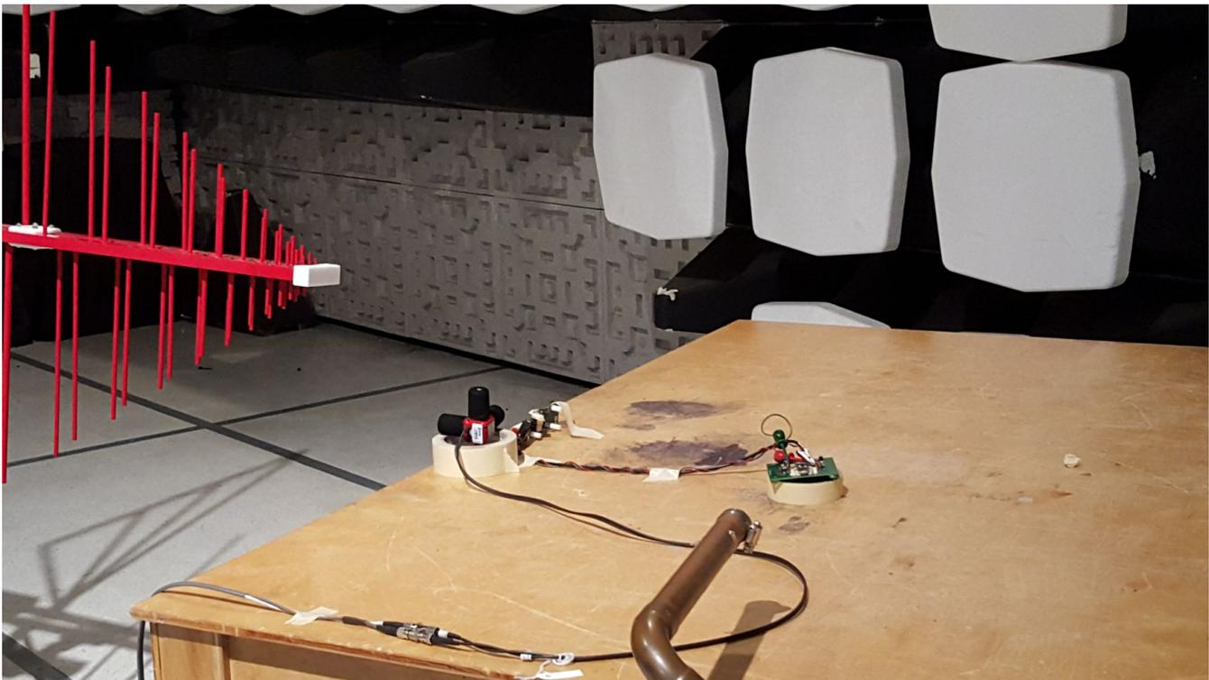
图 21. RF Immunity Test Setup
