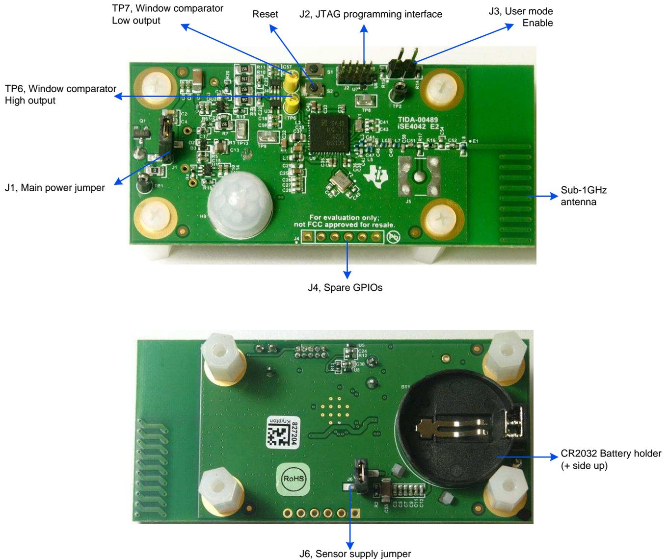
图 10. 低功耗无线 PIR 运动探测器参考设计硬件描述
