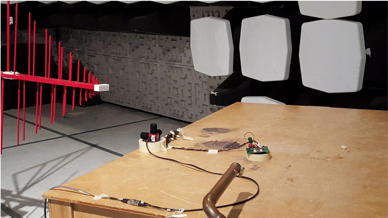
图 21. RF Immunity Test Setup
