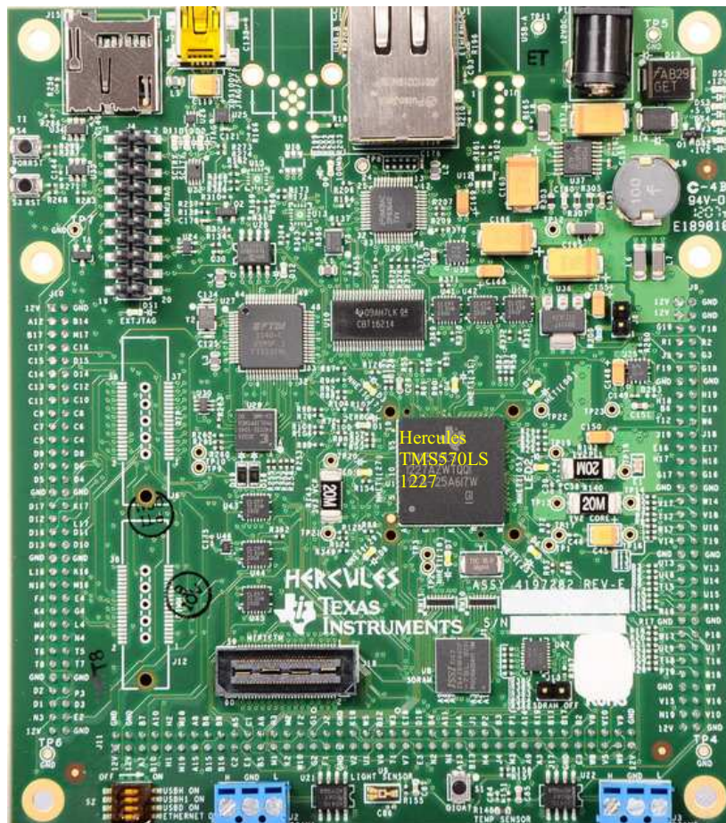
图 2-1. TMS570LS12HDK 电路板，接口顶部
