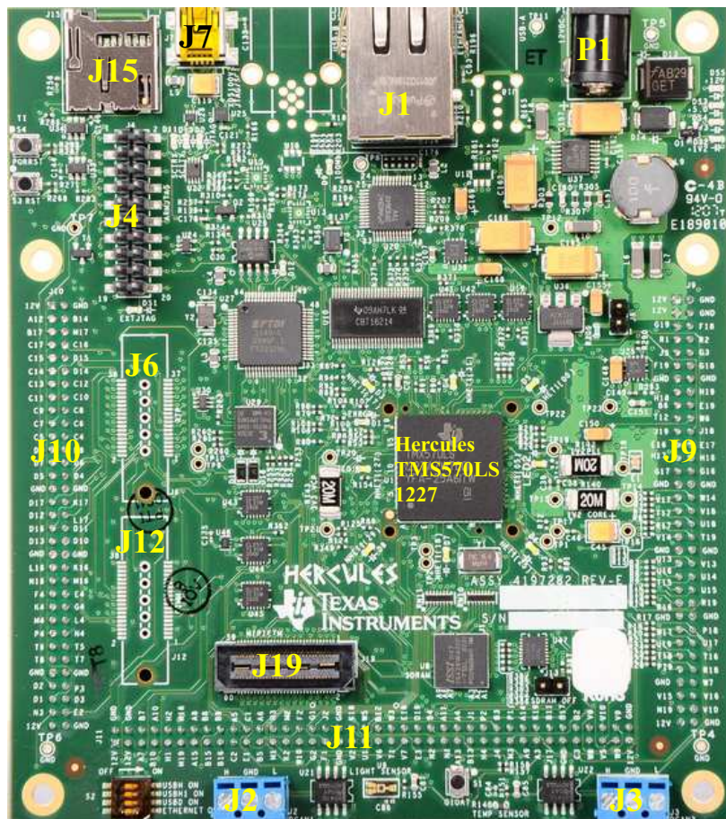
图 2-2. TMS570LS12HDK 上的连接器
