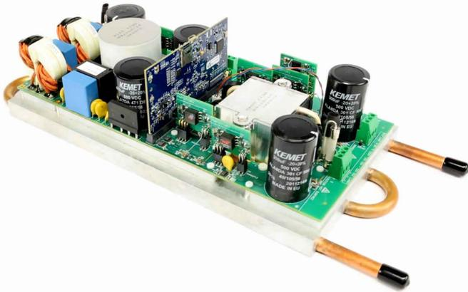
图 2. 带液冷冷板的 OBC 硬件。
