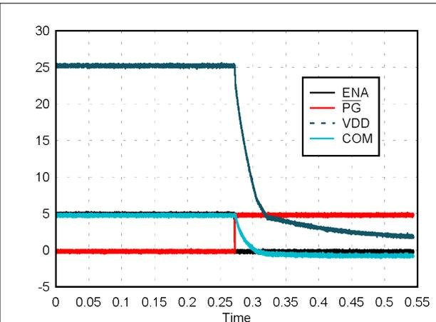
图 6-6. Shutdown:  $V_{IN} = 24\text{ V}$ ,  $V_{VDD-VEE} = 25\text{ V}$ ,  $V_{COM-VEE} = 5\text{ V}$ , No Load
