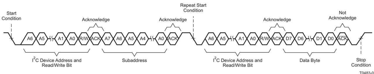
Figure 14. Single-Byte Read Transfer
