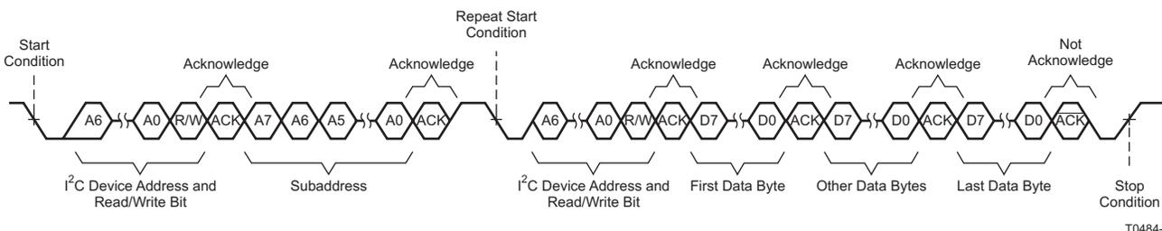
Figure 15. Multiple-Byte Read Transfer
