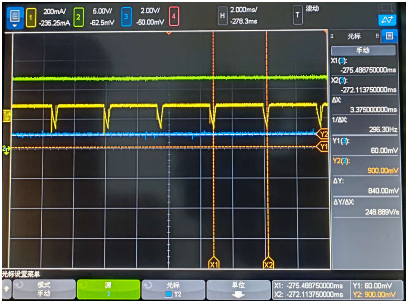
图 2-1. DRV8231 重启现象波形
