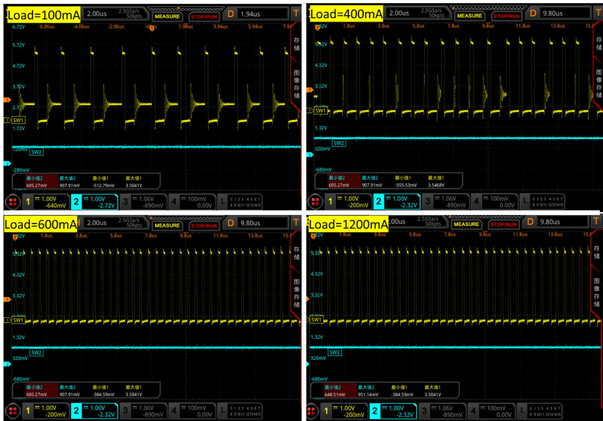
图 2-9. SW 随负载电流变化 1
