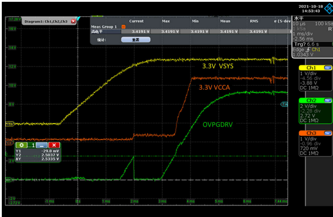
图 2-3. TPS6594 Fail Short BIST PASS 的波形
