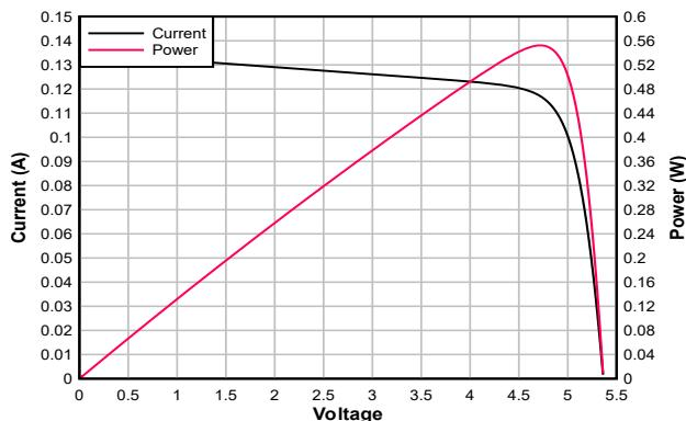
从所述特性中可以观察到，最大功率点电压约为 4.75V。在这种情况下，之前所述的电池将使用该输入源进行充电，配置的充电电流为 200mA（大于输入源的短路电流），并使用 4.7V 的 VINDPM 以及 BATTRACK 以便进行比较。充电结果如下：
