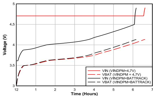
可实现更高的充电电流，从而缩短充电周期和充电持续时间。此外，可以根据充电周期特性提高效率。以热量形式耗散的能量更少，充电过程中的发热问题得到进一步缓解。
