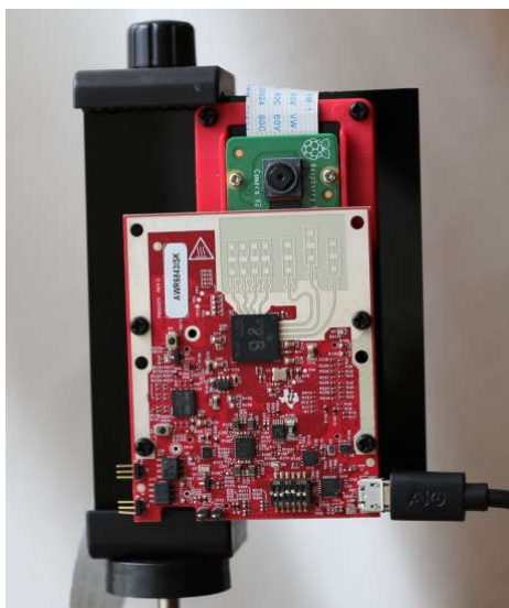
图 3. 采用 IMX219 和 IWR6843ISK 构建的摄像头和雷达传感器模块
