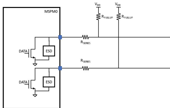
**图 8-1. 建议的 ODIO 电路**
