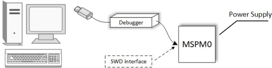
图 5-1. 主机到目标器件的连接
