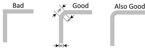
图 9-3. 直角弯曲布线的错误和正确方式
