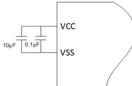
图 2-2. 电源去耦电路
