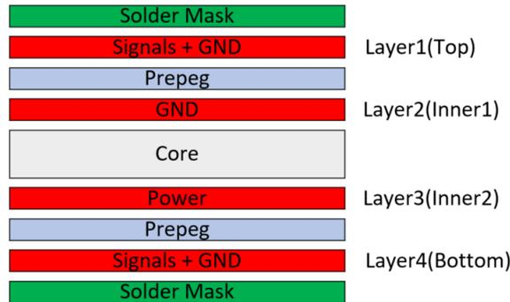
图 9-5. 四层 PCB 堆叠示例
