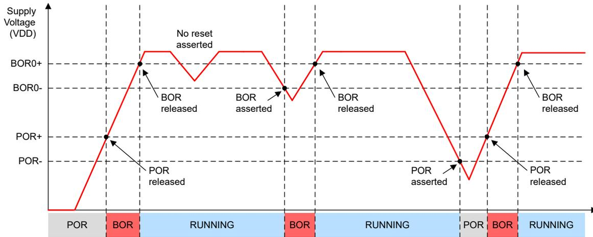
图 3-2. POR/BOR 与电源电压 (VDD) 间的关系
