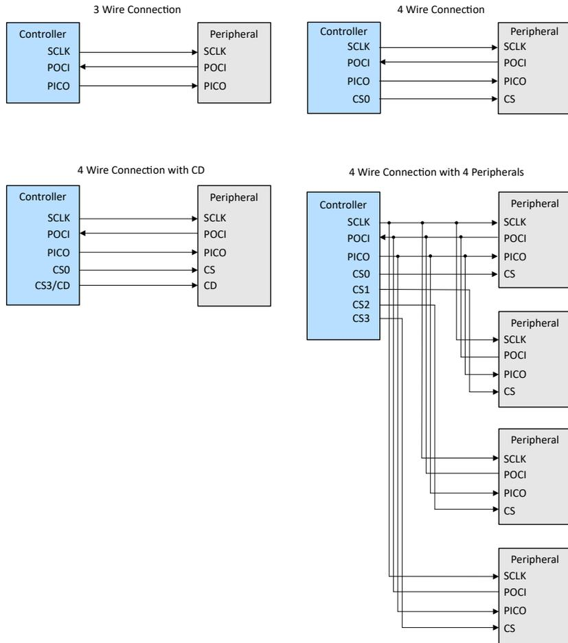
图 7-4. 针对不同 SPI 配置的外部连接
