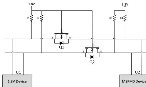
**图 8-2. 与 1.8V 器件通信的建议电路**
