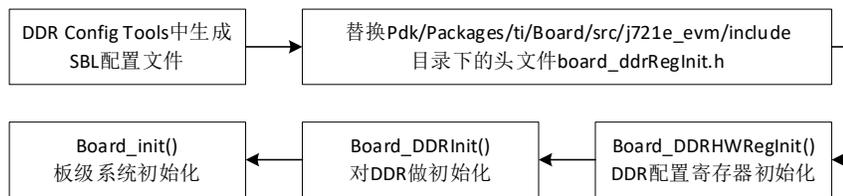
图 5 SBL 中配置 DDR 流程图
