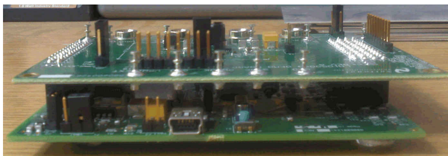
图 8-1. 将 LM10500 评估板连接到 USB2PWI 接口板
