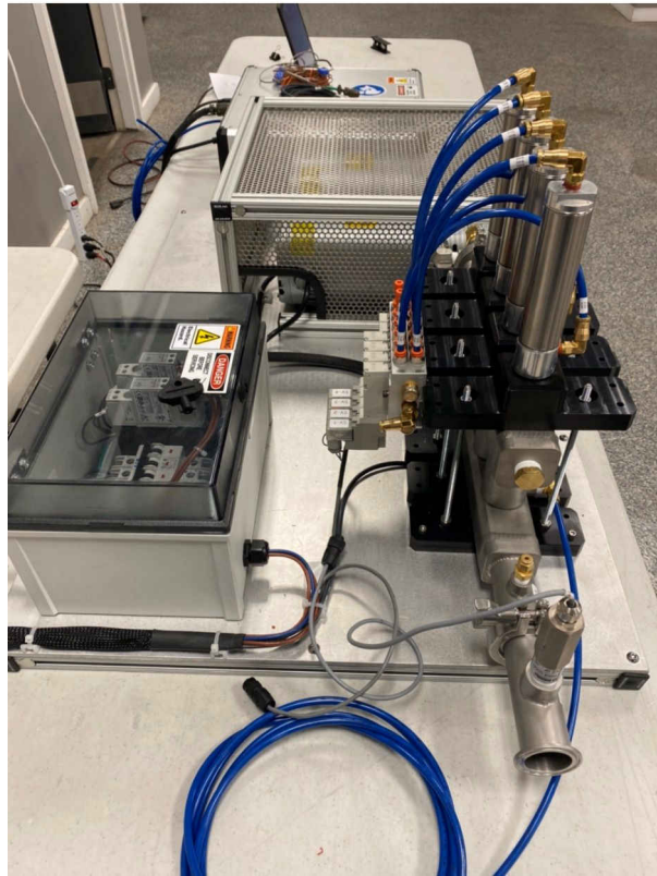
图 3-1. 音速喷嘴测试和校准系统
