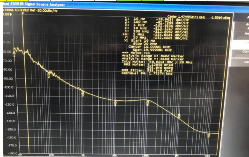
Figure 9 时钟随机噪声对 EVM 影响的实际测试
