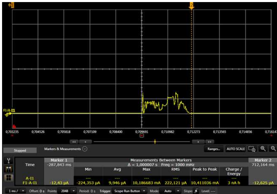
图 32. 连接事件：第 2 个标记放置
