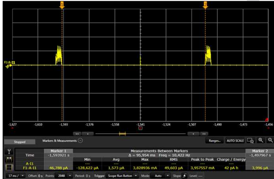
图 29. 在通告期间测量待机电流
