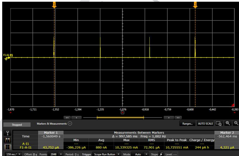
图 30. 在连接期间测量待机电流
