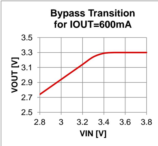
Figure 5 V<sub>OUT</sub> vs V<sub>IN</sub>
