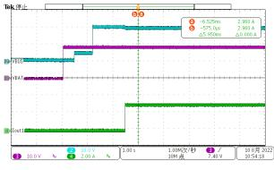
Figure 3-5. 18  $V_{\text{BAT}}$  to 20 V, 3 A Out OTG Mode
