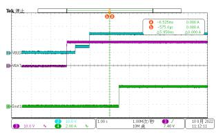
Figure 3-6. 18  $V_{\text{BAT}}$  to 15 V, 3 A Out OTG Mode
