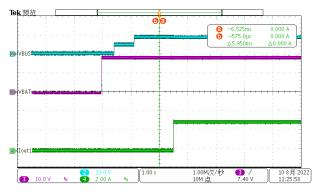
Figure 3-7. 18  $V_{\text{BAT}}$  to 9 V, 3 A Out OTG Mode
