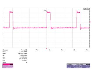
Figure 3-2. Switch Node Voltage, No Load, FPWM-Mode
