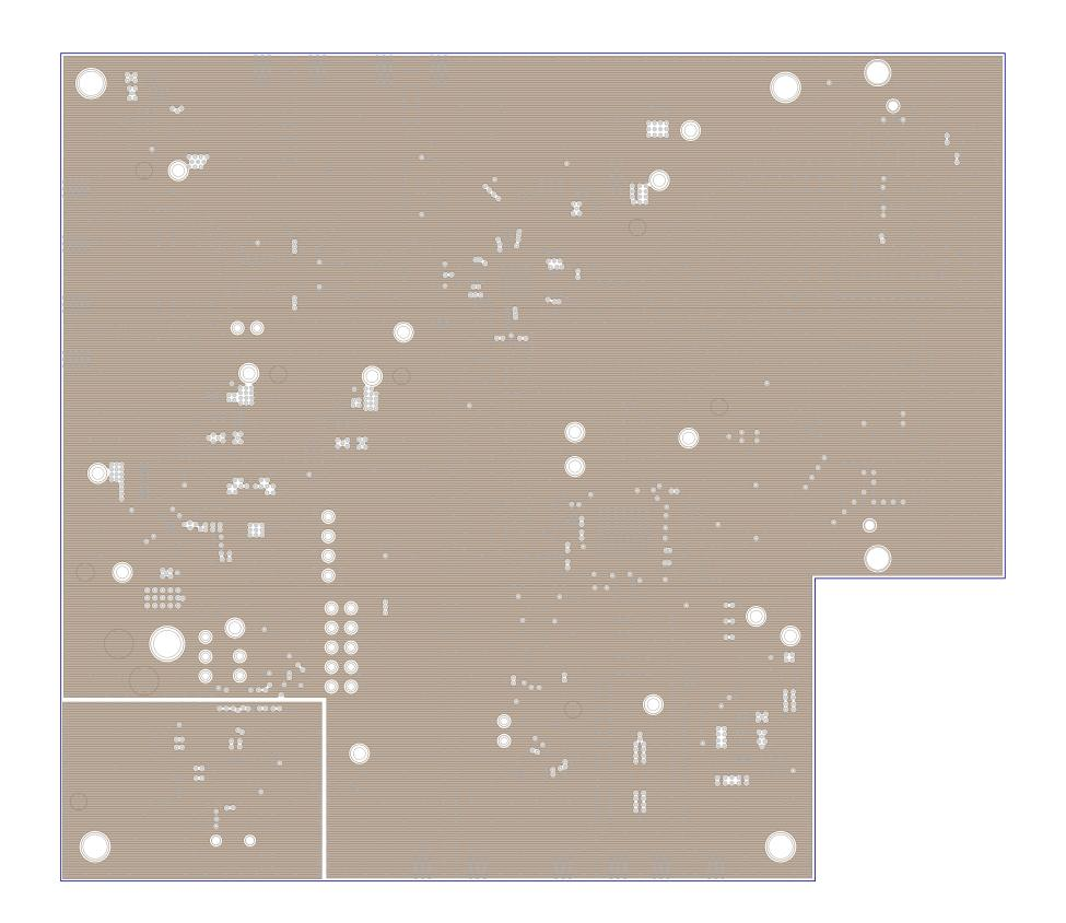
TEXAS INSTRUMENTS TSW14X500EVM PCB REV A L5 - GROUND PLANE
