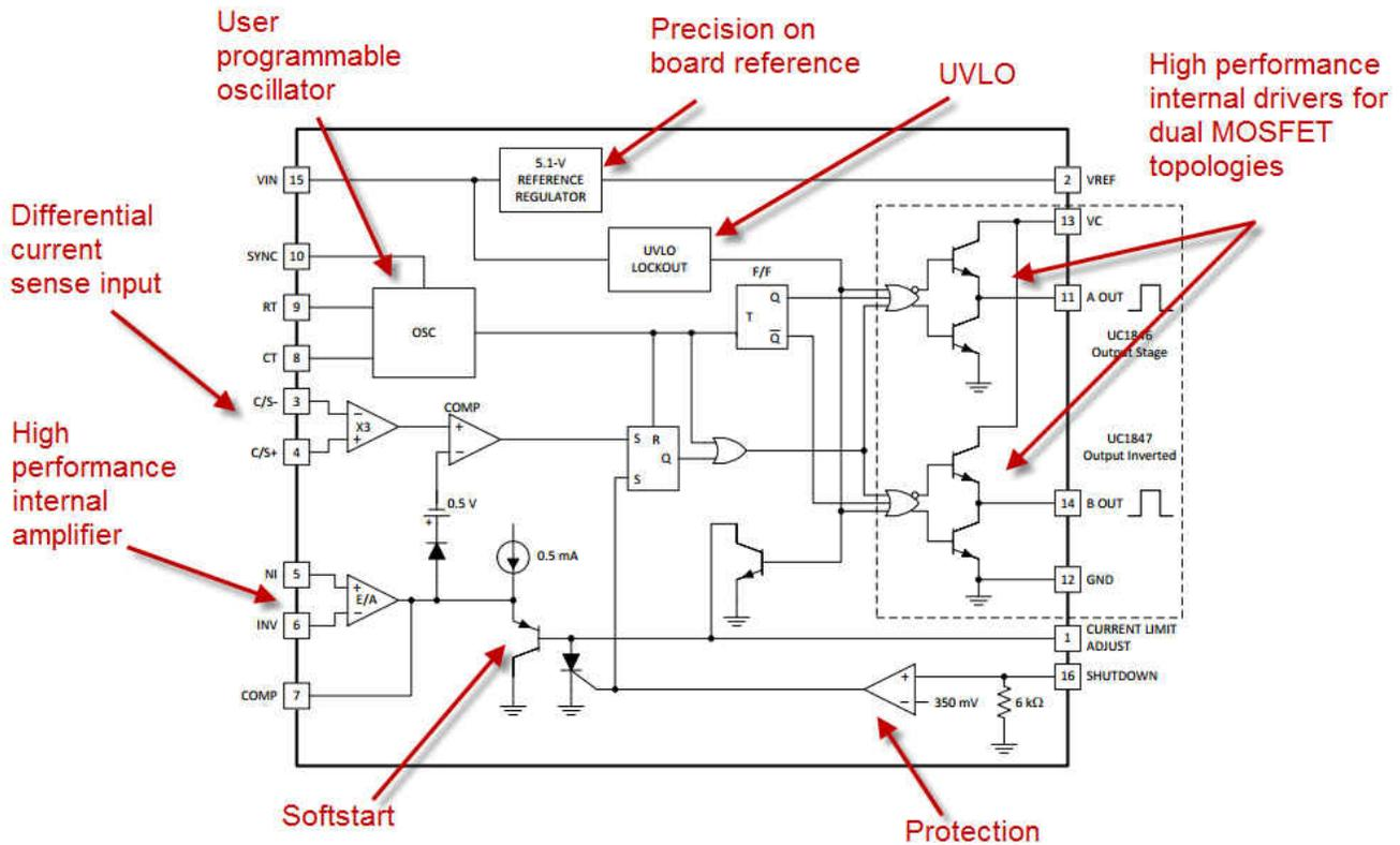
**Figure 1. UC3846 Block Diagram**
