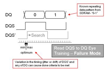
Figure 4. Read DQS to DQ Eye Training - Failure Mode
