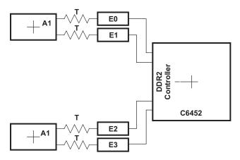
Figure 6. DQS and DQ Routing and Toplogy
