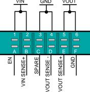
Figure 4. Edge Connector Schematic
