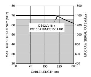
Figure 12. Typical Embedded Clock SER/DES + DS15BA101/DS15EA101 Reach over Belden 9914 (A Low Loss 50Ω Coaxial Cable)
