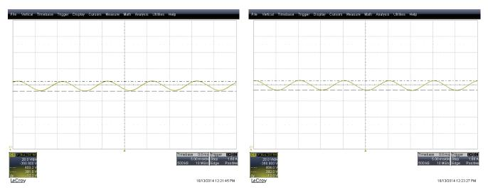
Figure 22. UCC29950EVM-631  $V_{\rm BULK}$  Voltage Ripple (115- $V_{\rm AC}$ , 60-Hz input, full load)
