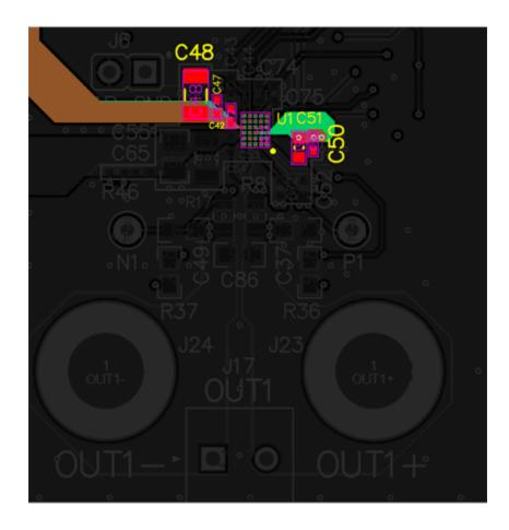
Figure 1-6. DREG Pin Connection
