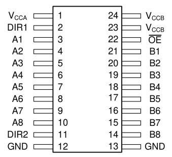
Figure 4-1. Pin Diagram
