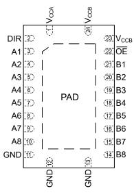
Figure 4-1. Pin Diagram (VQFN) Package
