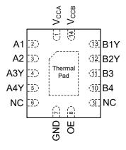
Figure 4-2. Pin Diagram (VQFN-14 Package)
