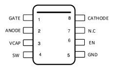
Figure 4-1. LM74701-Q1 Pin Diagram
