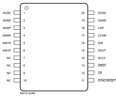
Figure 4-1. Pin Diagram
