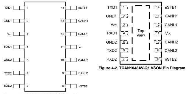
Figure 4-1. TCAN1048AV-Q1 SOIC Pin Diagram
