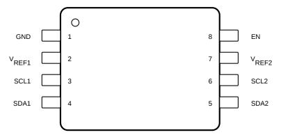
Figure 4-1. Pin Diagram
