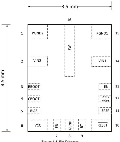
Figure 4-1. Pin Diagram
