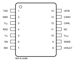
Figure 4-1. SOIC Pin Diagram
