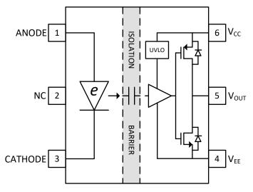
Figure 4-1. Pin Diagram
