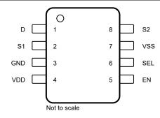
Figure 4-1. Pin Diagram
