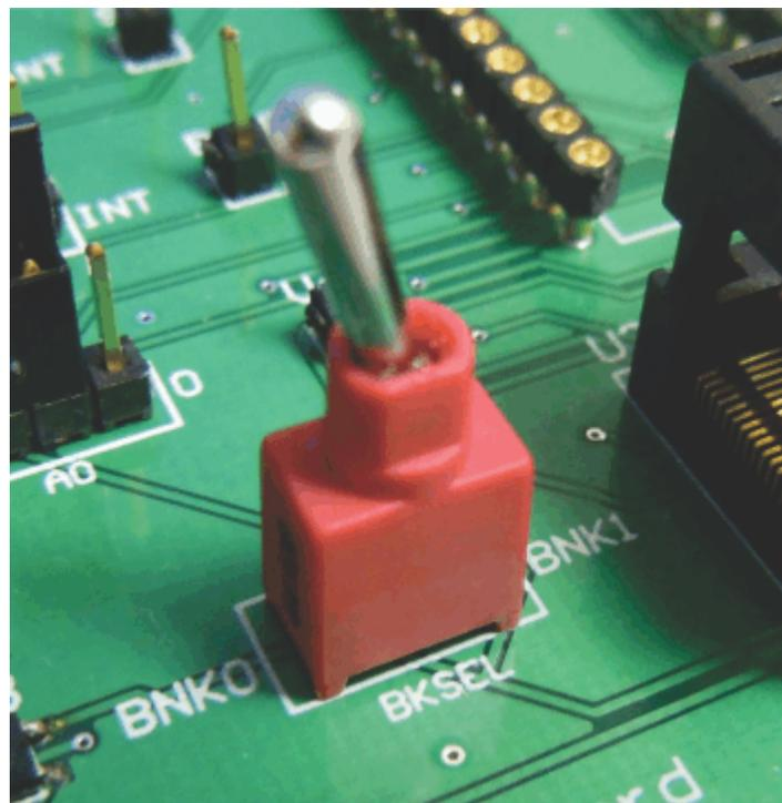
**Figure 10. BKSEL Switch**
